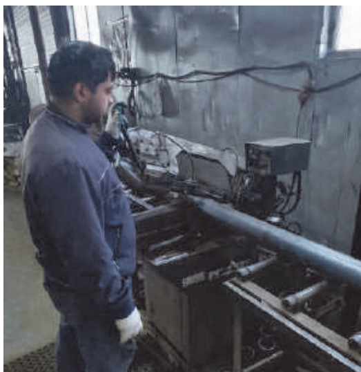
Рисунок 4 – Процесс резки трубы
