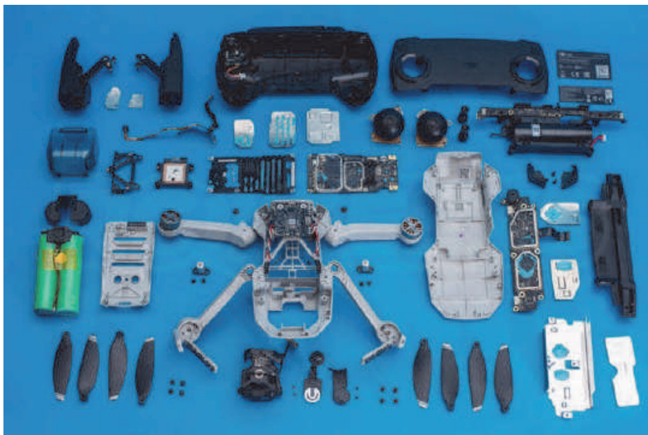
Рисунок 2 – Элементы конструкции дрона
