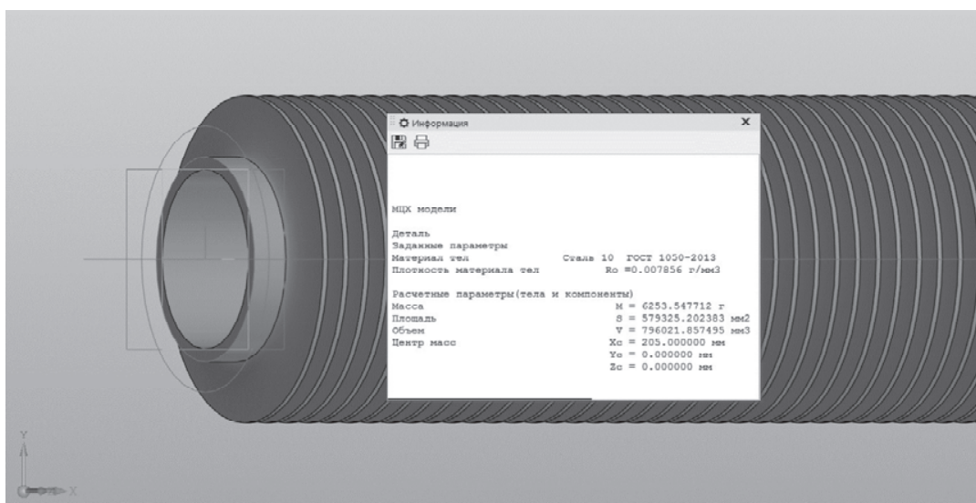
Рисунок 4 – Массо-центровочные характеристики для построенной в программном продукте КОМПАС-3D оребренной трубки экономайзера Источник: разработано автором
