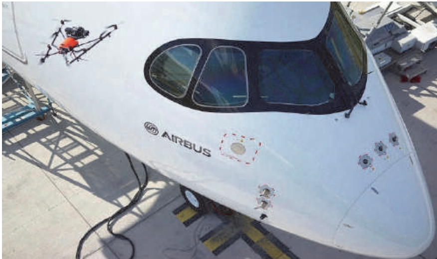
Рисунок 1 – Внешний осмотр обшивки ВС с помощью БПЛА
