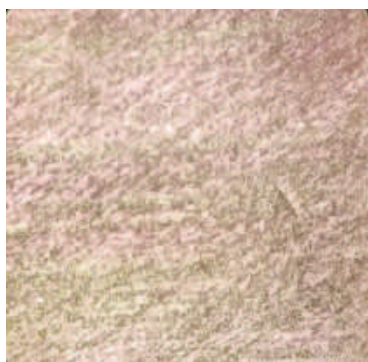
Рисунок 1 – Микроструктура: литой (а) быстрорежущей стали Р6М5К5 и (б) порошковой быстрорежущей стали Р6М5К5 ПМ (поперечное сечение) х100
