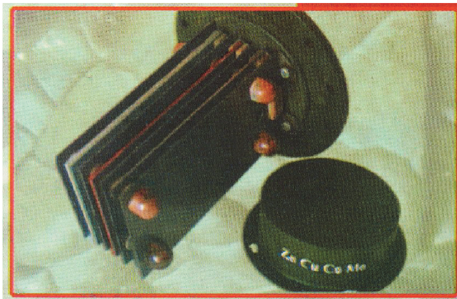
Рисунок 2 – Конструктивный вид блока электродной системы устройства
