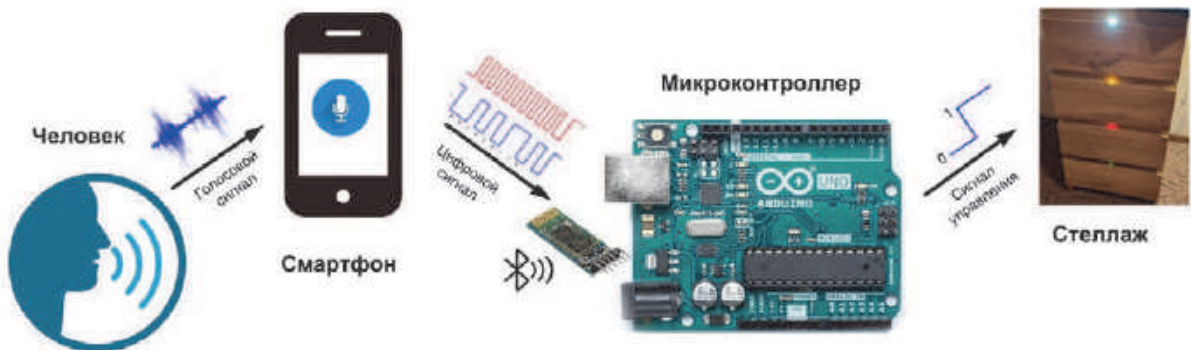
Рисунок 2 – Схема работы голосового управления
