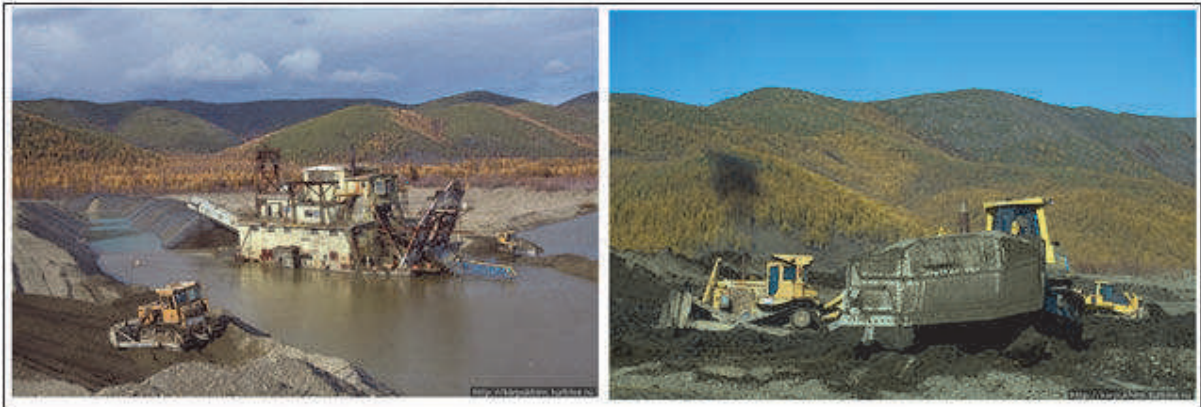
Рисунок 4 – Драги. Работы по промывке золотоносного песка. Прииск Мальдяк Сусуманского района Магаданской обл. Фотографии автора.
