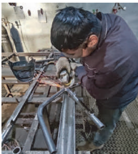
Рисунок 8 – Очистка места сварки
