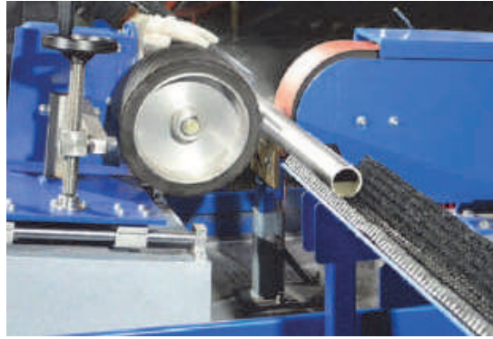
Рисунок 1 – Приёмно-подающее приспособление в виде жёлоба
