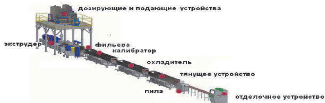
Рис. 1. Схема одношаговой линии экструзии
