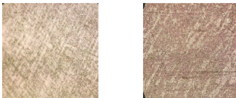
Рисунок 2 – Микроструктура: литой (а) быстрорежущей стали Р6М5К5 и (б) порошковой быстрорежущей стали Р6М5К5 ПМ (продольное сечение) \times 400
