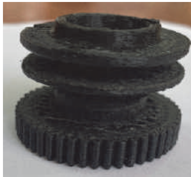
Рисунок 2 – Зубчатое колесо, изготовленное на оборудовании ЕТИ ФГБОУ ВО МГТУ «СТАНКИН»
